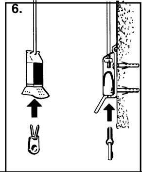
Der Dübel ist durch das Formloch der Grundplatte zu stecken.
