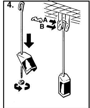
Schlitz A: für Gitterhöhe bis 35 mm  $L_1 = 320$  mm
